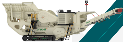
Track Mounted Jaw TMJ Series Kapasitas : 150 TPH sampai 400 TPH Ukuran Pengumpanan : 635 mm
