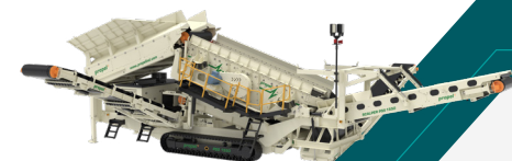
Track Mounted Scalper PSS 1550 Kapasitas : Sampai 600 TPH Ukuran Dek Atas : 1540 mm x 4800 mm
