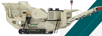
Track Mounted Jaw TMJ فتة السعة : 400 TPH إلى 150 TPH حجم فتحة التغذية (الحد الأقصى) : 635 mm
