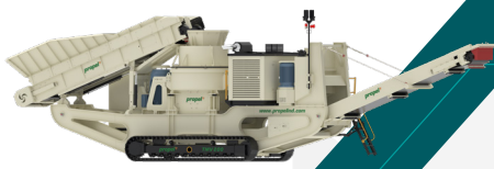
Track Mounted VSI TMV فتة السعة : 470 TPH إلى 180 TPH حجم فتحة التغذية : 66 mm إلى 58 mm
